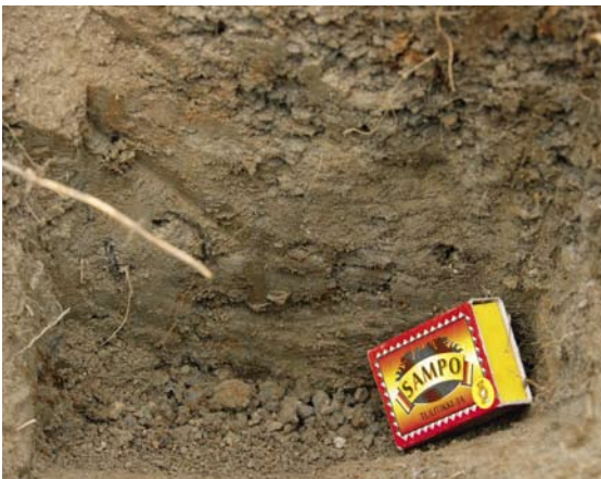
Kuva 14. Litorinasavea pellolla (kuva 38). Savelle ovat tunnusomaisia eloperäiset ruskeat raidat. Savi on lihavaa (rakeisuus alle 0,002 mm), ja sen veden läpäisykyky on huono. Litorinasavea esiintyy vain rannikkoseudulla Litorinameren peittämällä alueella, jonka raja on merkitty Suomen maaperäkartalle. Pohjaveden saanti savesta ei ole mahdollista.
