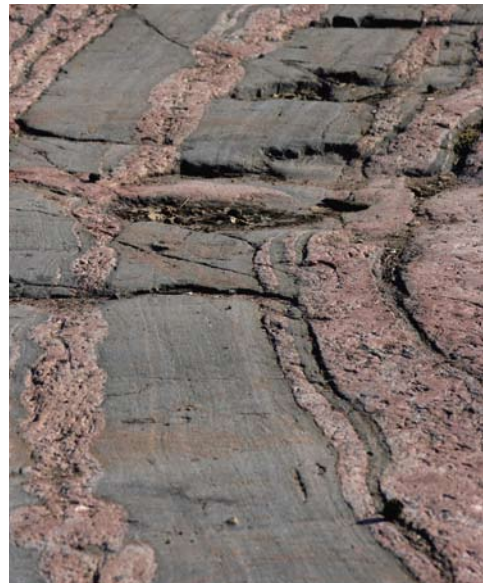
Kuva 22. Kapeita pegmatiittijuonia harvarakoisessa (rakoluku RLI) kiilleliuskeissa. Tällaisten juonikivien [9] kivilajien rajapintoihin liittyy usein rakoilua. Rajapinnat ovat osoittautuneet kallioporakaivojen teon yhteydessä saatujen kokemusten perusteella usein hyväksi ”vesisuoniksi”. Kiilleliuskeissa voi esiintyä terveydelle haitallista arseenia.
